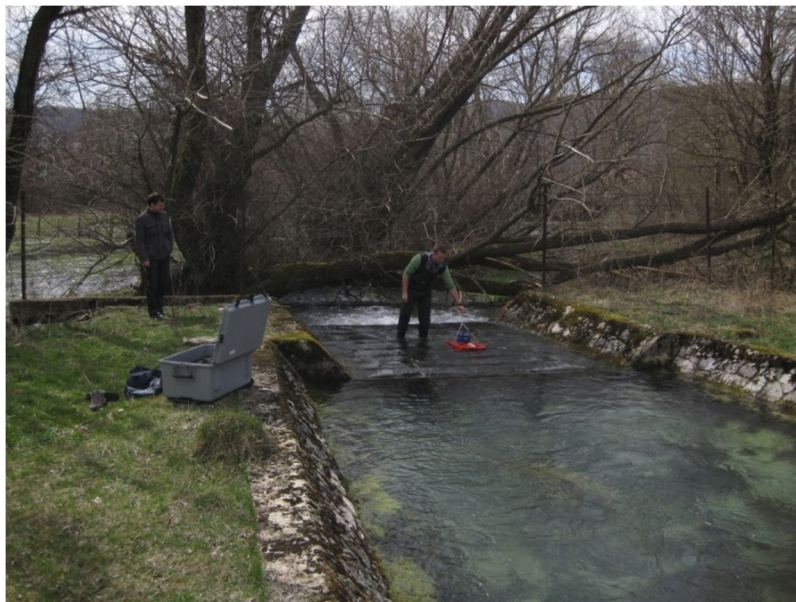
Slika 6. Mjerenje protoka u betoniranom profilu nizvodno od kaptaje
